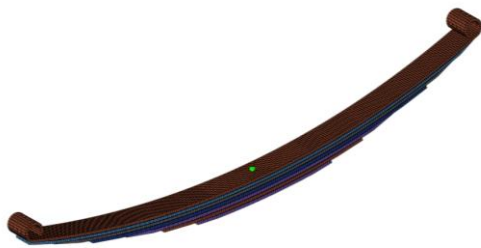
Hình 8. Mô hình phần tử hữu hạn của bộ nhíp lá
