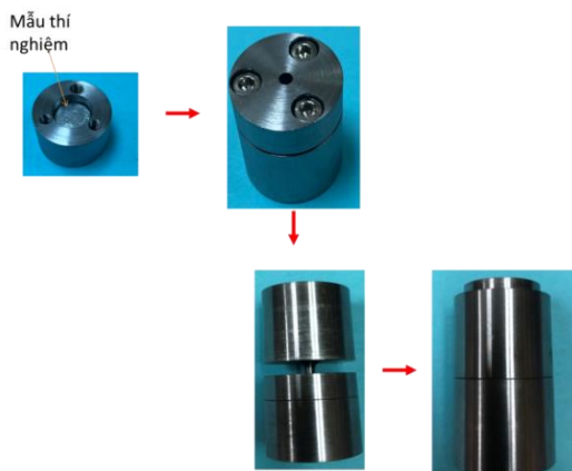
Hình 5. Sơ đồ gá đặt mẫu thí nghiệm và lắp đặt khuôn dập mẫu nhỏ
