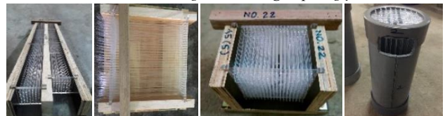
Hình 12. Các loại khuôn sử dụng trong nghiên cứu bê tông truyền sáng (khuôn mẫu đo cường độ uốn nén theo phương song song và vuông góc với sợi quang, khuôn mẫu đo truyền sáng, khuôn mẫu đo chống thấm)
