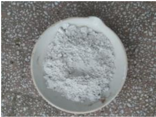
Hình 3. Hình ảnh xi lò cao Hoà Phát (Quảng Ngãi)
