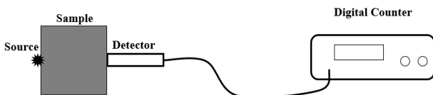
Hình 4. Sơ đồ thiết bị đo hệ số suy giảm tuyến tính [7]
