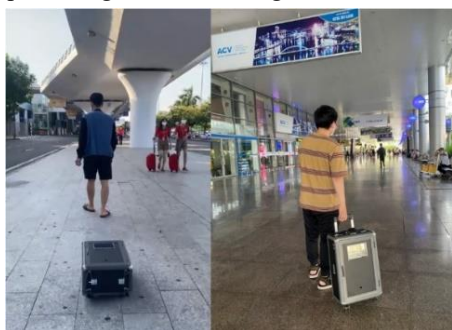
Hình 21. Chạy thử chức năng theo sau người dùng và tự hành tại Cảng Hàng Không Quốc Tế Đà Nẵng
