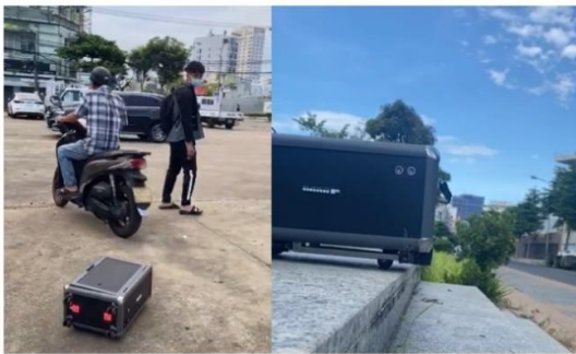
Hình 10. Chạy thử thực tế các chức năng tránh vật cản và bậc thang tại Bãi đỗ xe Nhà hát Trưng Vương Đà Nẵng
