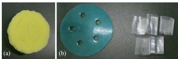
Hình 1. Các loại giá thể (a) Giá thể bột biển; (b) Giá thể film nylon
