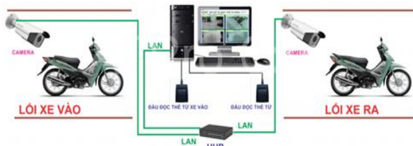
Hình 1. Hệ thống giữ xe với thẻ từ RFID và CAMERA để chụp và lưu trữ ảnh biển số xe [3]
