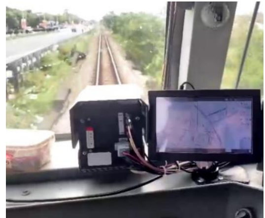
Hình 7. Hình ảnh giao tiếp của thiết bị trên đầu máy ở trạng thái ghi băng
