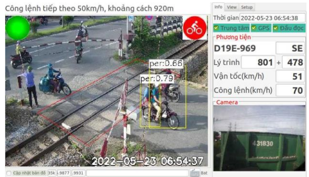
Hình 7. Hình ảnh giao tiếp của thiết bị trên đầu máy ở trạng thái ghi băng
