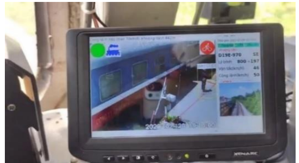
Hình 8. Hình ảnh giao tiếp của thiết bị trên đầu máy ở trạng thái qua đường ngang
