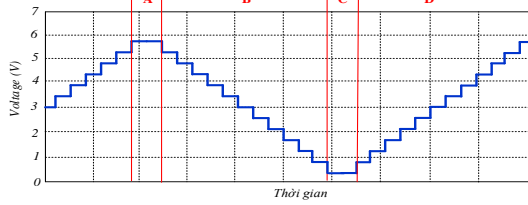
Hình 6. Trạng thái điện áp AC đầu ra của bộ MMC
