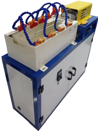
Hình 10. Hình ảnh thực tế của khâu định hình và làm mát
