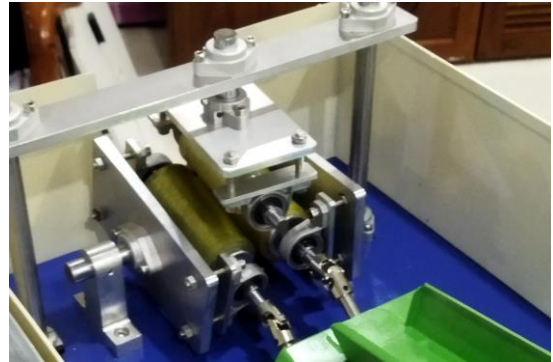
Hình 12. Hình ảnh thực tế của cụm cơ cấu dẫn hướng và kéo sản phẩm
