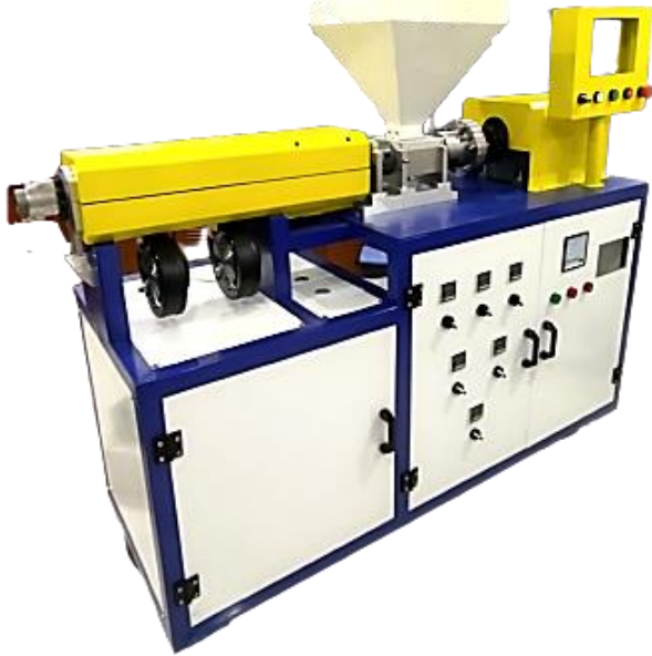
Hình 7. Hình ảnh thực tế của khâu đùn nhựa
