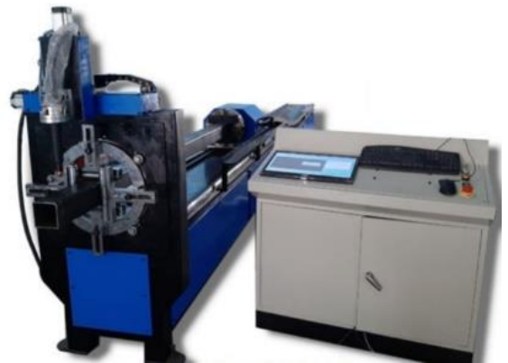
Hình 1. Máy cắt ống Plasma 3 trục [4]
