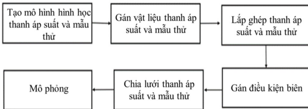
Hình 3. Các bước để thiết lập mô phỏng mô hình thí nghiệm bằng phần mềm Abaqus
