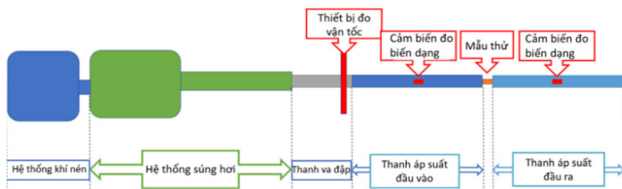
Hình 1. Mô hình thí nghiệm nén vật liệu dựa trên nguyên lý áp lực súng bắn Hopkinson
