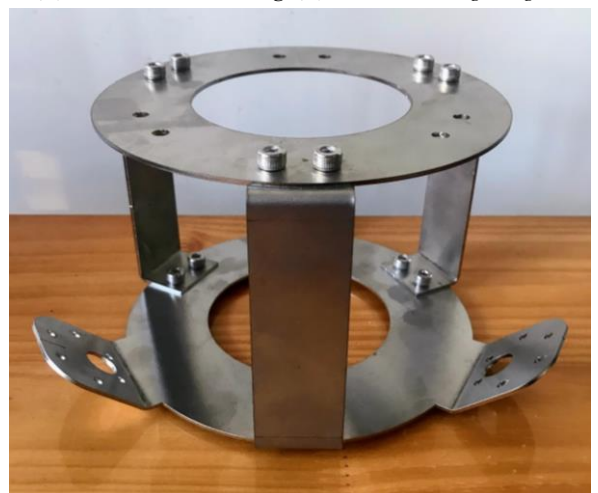
Hình 12. Khung chính của BBR sau khi chế tạo
