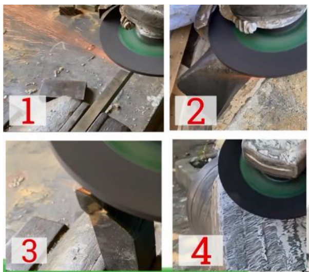
Hình 21. Kiểm tra chất lượng bề mặt trục sau khi hàn PTA
