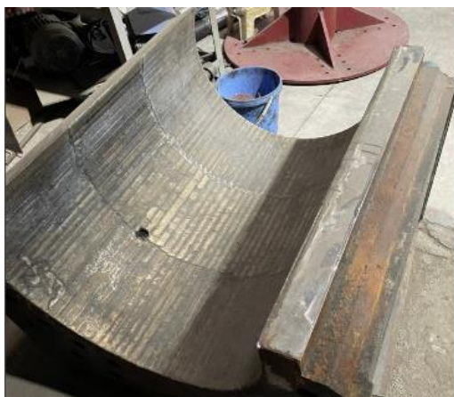
Hình 20. Bề mặt buồng luyện sau khi hàn PTA
