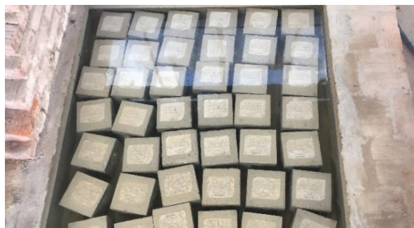
Hình 5. Dưỡng hộ mẫu bê tông tại Phòng thí nghiệm
