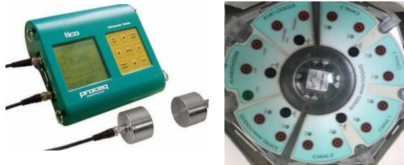
a) Máy siêu âm Tico Proceq b) Thiết bị SYSAM-SP5
