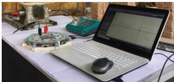
Hình 8. Kết nối thiết bị để thu nhận xung siêu âm
