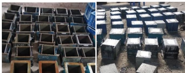
Hình 4. Khuôn và mẫu bê tông chế tạo tại Phòng thí nghiệm Trường Đại học Bách khoa – Đại học Đà Nẵng
