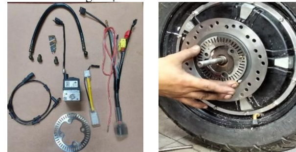
Hình 7. Hình ảnh các chi tiết của hệ thống ABS lắp cho xe gắn máy
