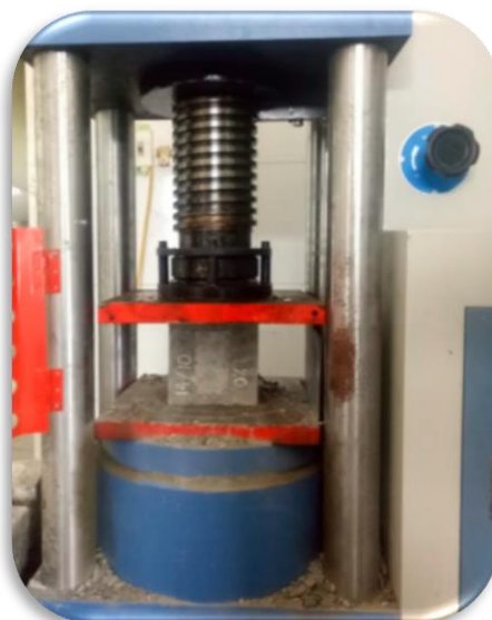
Hình 7. Máy đo cường độ nén của mẫu bê tông 3000 kN
