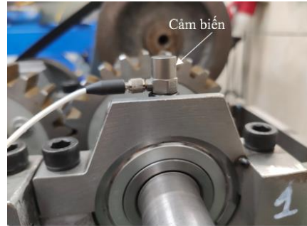
Hình 13. Vị trí đo gia tốc PZ1 trên trục bị động
