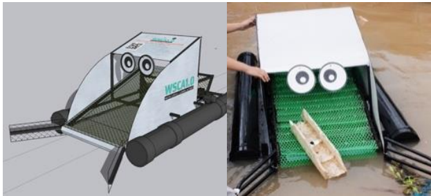
Hình 3. Bản mẫu 3D và bản thử nghiệm của WSCA vận hành thử nghiệm tại chợ nổi Cái Răng, thành phố Cần Thơ
