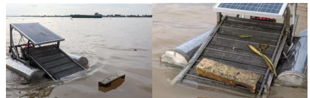
Hình 4. Mô hình thiết kế 3D và thực tế vận hành của WSCA
