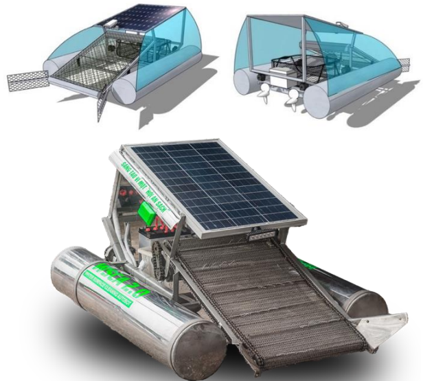
Hình 3. Bản mẫu 3D và bản thử nghiệm của WSCA vận hành thử nghiệm tại chợ nổi Cái Răng, thành phố Cần Thơ
