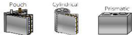
Hình 3. Các loại sản phẩm pin dạng túi, pin dạng trụ tròn và pin dạng lăng trụ
