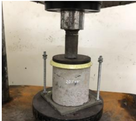
Hình 3. Thí nghiệm cường độ chịu nén trên mẫu đã được làm phẳng bề mặt
