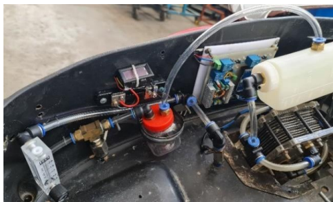
Hình 16. Ảnh chụp hệ thống sản sinh HHO và ECU điều khiển phun HHO trên đường nạp động cơ Honda Lead
