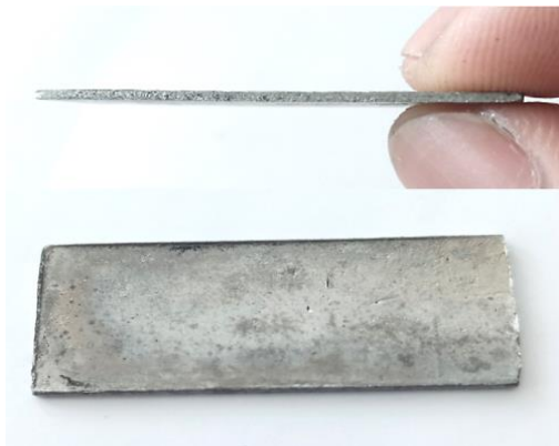
Hình 9. Sản phẩm bột bạc nano sau khi thiêu kết dày 1\text{ mm}
