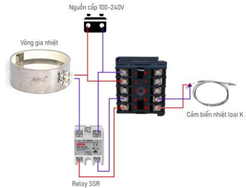
Hình 6. Sơ đồ kết nối bộ điều khiển nhiệt độ Rex-C100 với vòng gia nhiệt [26]
