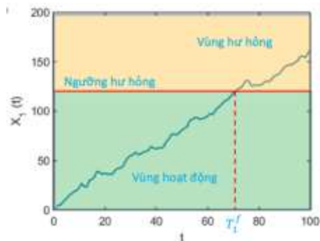
Hình 1. Quá trình hư hỏng của thiết bị [2]
