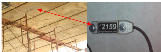
Hình 3. Lắp đặt 12 cảm biến đo biến dạng-ứng suất tại vị trí giữa nhịp dầm bản
