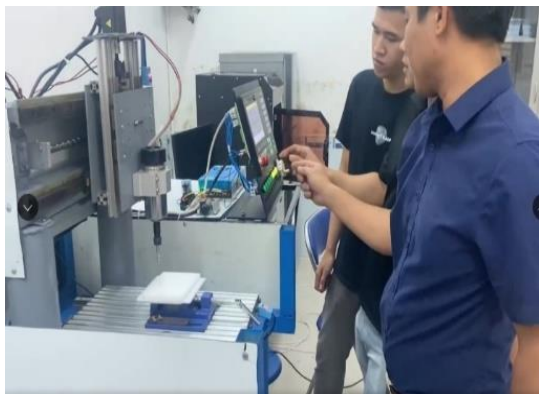
Hình 10. Lập trình chạy mẫu trên CNC Router
