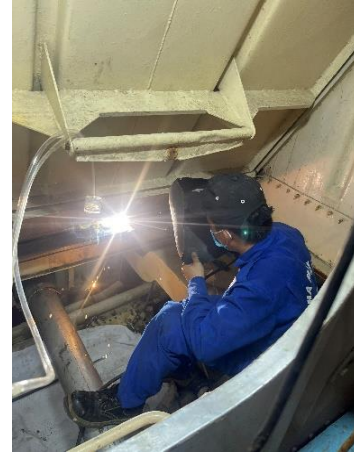
Hình 9. Thu mẫu khói hàn tại hiện trường trong không gian kín ở khoảng cách 0,4m (từ đầu thu mẫu đến mỗi hàn)
