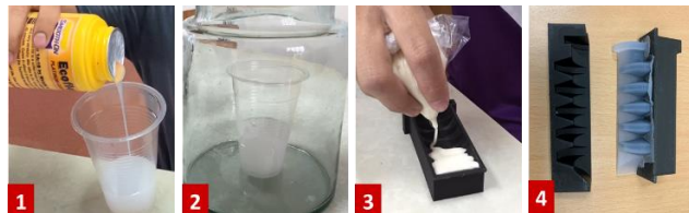
Hình 12. Các bước cơ bản của quá trình đúc ngón tay gấp mềm, 1 – khuấy silicon, 2 – khử bọt khí, 3 – rót silicon vào khuôn, 4 – tháo sản phẩm khỏi khuôn và lắp ghép
