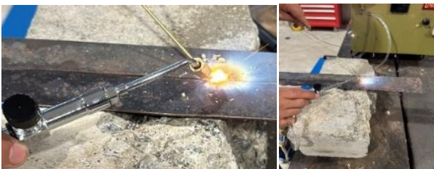
Hình 26. Sản phẩm sau khi hàn 2 tấm thép
