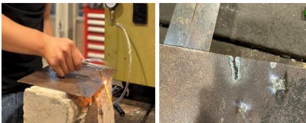
Hình 25. Kết quả sau khi cắt thép dày 2mm
