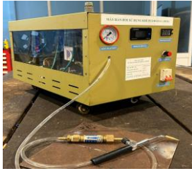
Hình 19. (a) Máy hàn khí HHO; (b) Nguyên lý làm việc
