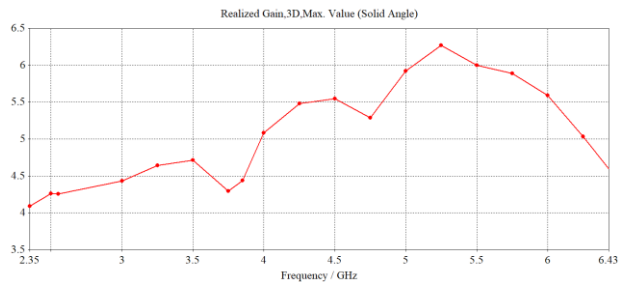
Hình 18. Hệ số khuếch đại hiệu dụng của ăng ten MIMO được đề xuất
