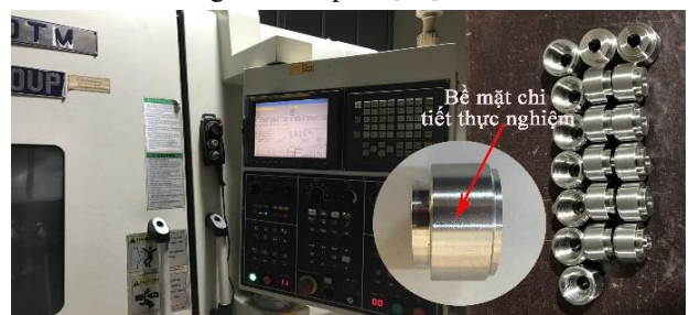
Hình 1. Máy tiện CNC EL 550TM và sản phẩm được sử dụng để thực nghiệm [20]
