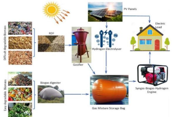
Hình 5. Sơ đồ hệ thống năng lượng tái tạo lai năng lượng mặt trời-sinh khối
