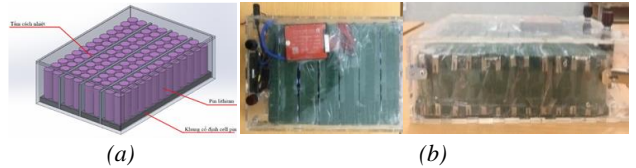
Hình 13. Khối pin lithium sử dụng các tấm cách nhiệt (a) và mô hình thực tế (b)
