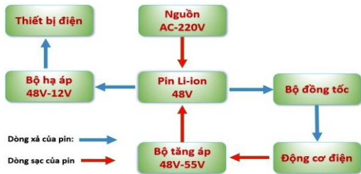
Hình 5. Tổng thể mạch sạc - xả của pin Li-ion sử dụng trên xe
