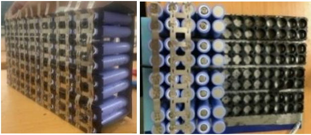
Hình 10. Thiết kế và định hình khay giữ và hàn các cell
