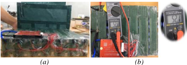
Hình 12. Mô hình thực tế sau khi đã hàn mạch bảo vệ vào khối pin (a) và điện áp định danh của toàn bộ khối pin (b)
