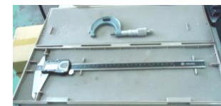
Hình 8. Thước cặp 1/100 300mm và Panme 0,01_(25-50)
