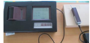
Hình 9. Máy đo độ nhám Mitutoyo SJ-301
