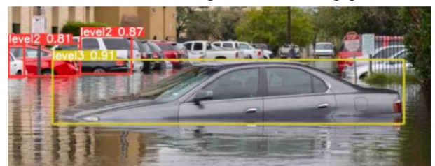
Hình 3. Kết quả phân tích độ sâu ngập lụt bằng mô hình YOLOv8 [14]
