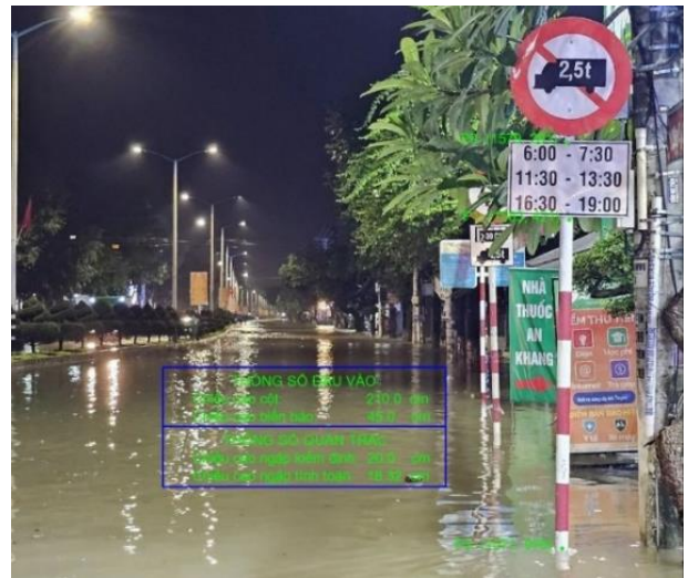
Hình 12. Kết quả xử lý ảnh từ mô hình cho hình ảnh ngập lụt thực tế tại Nha Trang [17]
