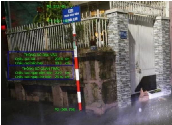
Hình 10. Kết quả xử lý ảnh từ mô hình cho hình ảnh ngập lụt thực tế tại Đà Nẵng [16]
